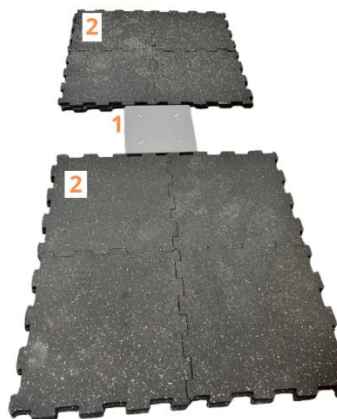
Obr. 28 Umiestnenie Vernier silovej platne (1) do roviny s podlahou (2).
