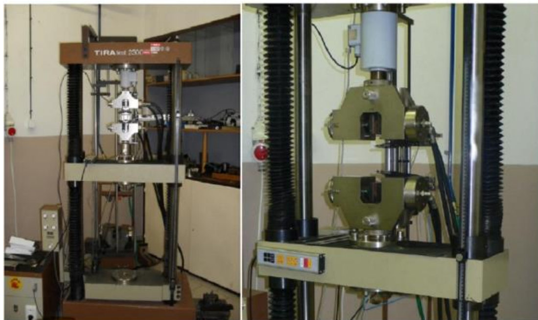
Obr. 7.12 Hydraulický trhací stroj TIRA-test 2300
