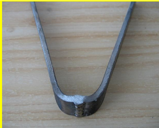
Obr. 12.8 Skúšobná vzorka po ohnutí
