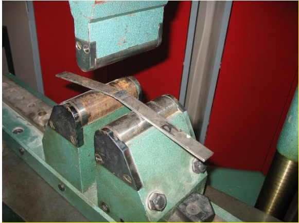
Obr. 12.7 Skúšobná vzorka tupého zvaru pred skúškou ohybom
