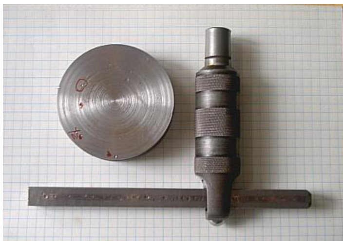
Obr. 10.5 Poldi kladivko (1 – úderník, 2 – referenčná tyč, 3 – meraný materiál)
