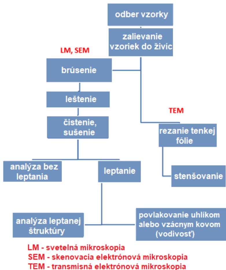
Obr. 3.1 Postup prípravy vzoriek na metalografické štúdium
