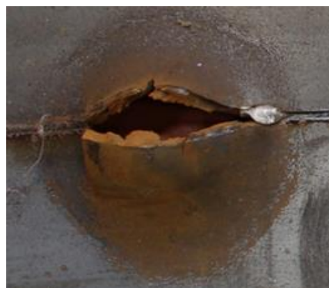
Obr. 12.11 Vzorka laserom zváraných plechov po skúške hĺbeným, nevyhovujúca pre hlboké ťahanie
