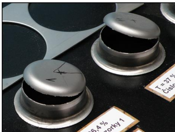
Obr.2.17 Vzhľad vzoriek po skúške hĺbením podľa Engelhardta
