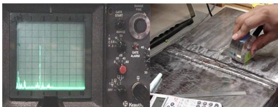
Obr.2.37 Kontrola tupého zvarového spoja
