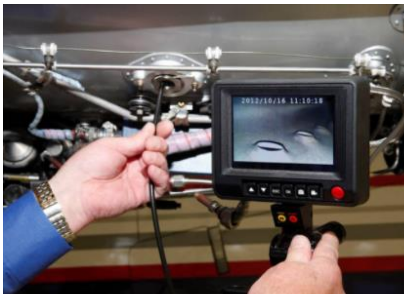
Obr.2.22 Nepriama vizuálna kontrola pomocou boroskopu
