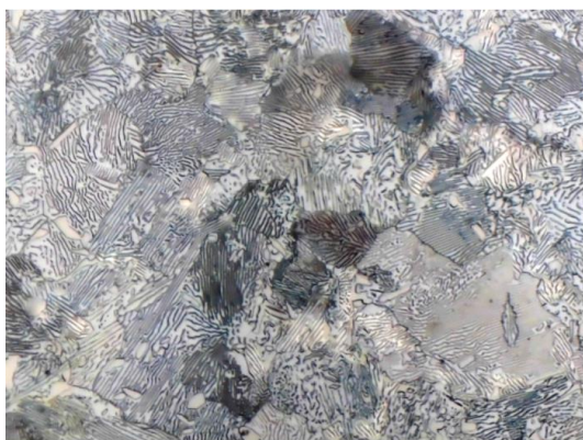
Obr.3.17 Štruktúra eutektoidnej ocele (0,8 % C) Obr.3.18 Mikroštruktúra nadeutektoidnej ocele (1 % C)
