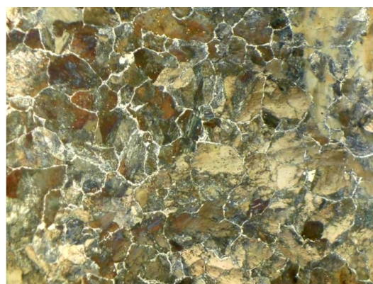
Obr.3.17 Štruktúra eutektoidnej ocele (0,8 % C) Obr.3.18 Mikroštruktúra nadeutektoidnej ocele (1 % C)
