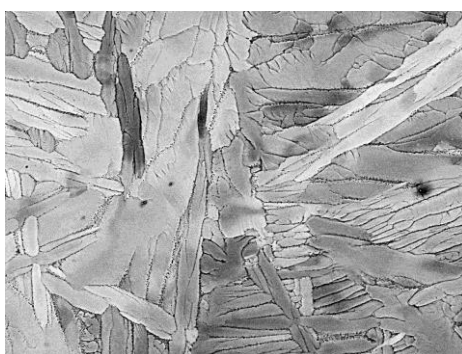
Obr.5.18 Mikroštruktúra zliatiny Zirkalloy, zv.200x
