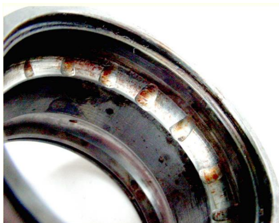
Obr. 31 Príklad vibračne opotrebenej súčiastky – krúžok valivého ložiska
