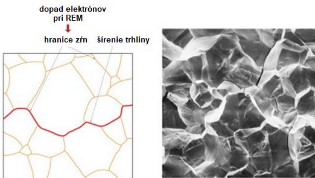
Obr. 6 Schéma interkryštalického šírenia lomu a skutočný vzhľad lomovej plochy, REM
