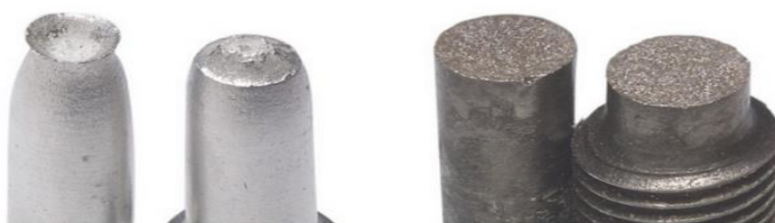
Obr. 9 Vzhľad húževnatého (vľavo) a krehkého (vpravo) lomu
