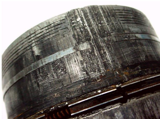
Obr. 25 Príklad abrazívne opotrebenej súčiastky – piest spaľovacieho motora
