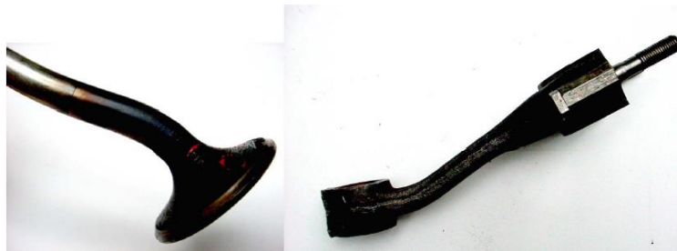
Obr. 2 Príklad medzného stavu – deformácie ventilu a ojnice motora
