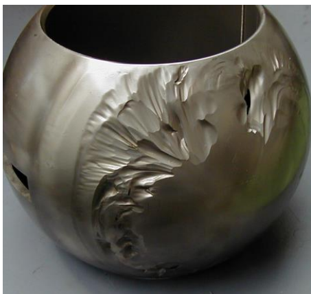
Obr. 26 Schéma princípu erozívneho opotrebenia (vľavo) a vzhľad povrchu poškodeného erozívnym opotrebením (vpravo)
