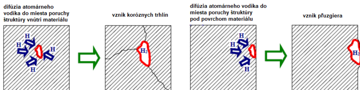
Obr. 32 Schéma vzniku vodíkovej krehkosti
