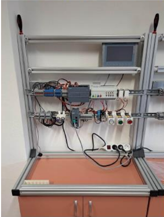
7 modulárnych staníc PLC/HMI
