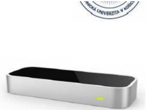
LEAP MOTION - Zariadenie pre sledovanie rúk vo virtuálnej realite
