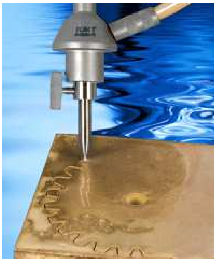
Obr. 2 Hlavica od firmy KMT Autoline II pri rezaní materiálu. Zdroj:5
