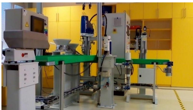
Obr.7 Pracovisko s robotom Scara a kamerovým systémom Omron F150-3
